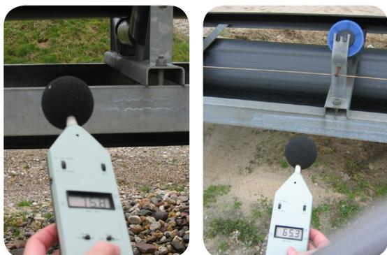
Le rouleau TQ, quant à lui, diminue tous les bruits, tant au niveau de manteau que des bagues de roulement. Cela permet de réduire la production de bruit d'au moins 10 Dba. Grâce au moulage par injection, le manteau est parfaitement rond, alors qu'un rouleau en acier présente toujours une sur épaisseur au niveau du cordon de soudure.
