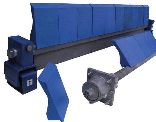
Очиститель конвейерной ленты обычно предлагается вместе окрашенными в синий цвет полиуретановыми сегментами шириной 150 мм - гальванизированная конструкция, состоящая из упругих элементов. Ширина установки меняется. Нетрудно поставить разрозненные сегменты и установить их взамен сработавших.
