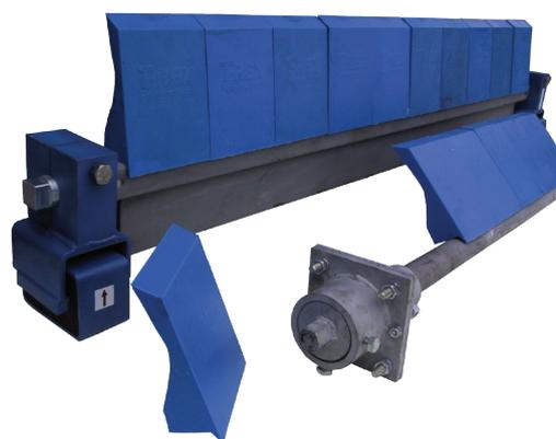
O raspador para correia transportadoras inclui segmentos azuis em poliuretano, de série: segmento com 150 mm de largura, fabrico galvanizado, incluindo elementos tensores. A largura de montagem é variável. Os segmentos podem ser fornecidos individualmente e são facilmente substituídos.
