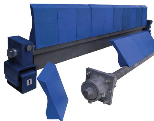
Il raschianastro di serie T-Rex PUR è dotato di segmenti in poliuretano di colore blu. La larghezza dei segmenti è di 150 mm, la struttura è zincata e tiene gli elementi tenditori. La larghezza di montaggio è variabile. Sono disponibili anche i segmenti sfusi, facilissimi da intercambiare.
